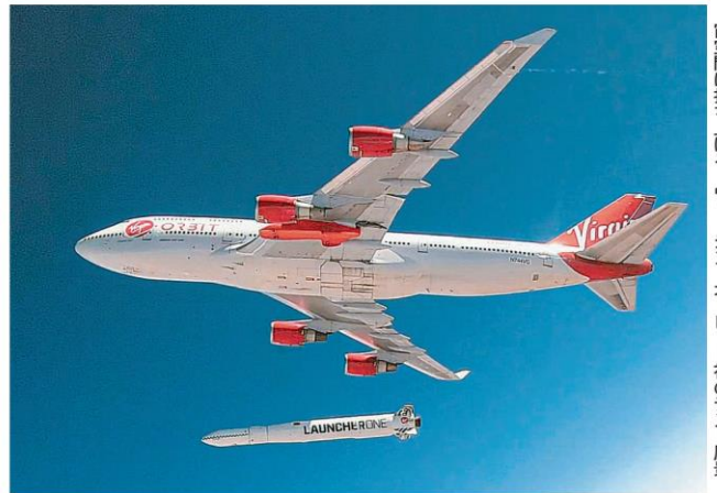
飛行中の航空機から小型衛星を搭載したロケットを発射し、宇宙空間に打ち上げる。ヴァージン・オービット社のテスト風景
