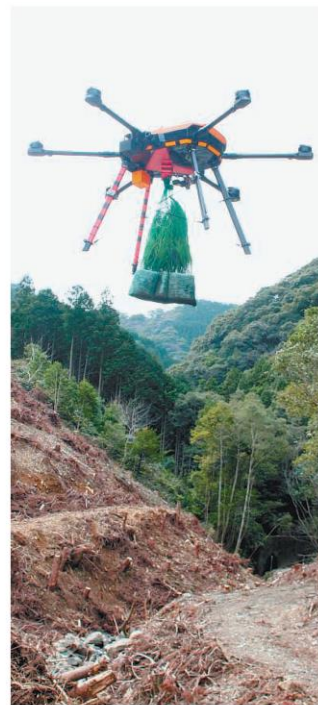
シカの食害防護ネットを運搬する林業用ドローン
